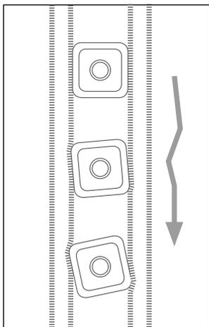
**Des probl mes d'orientation d'articles de forme (bouteilles, flacons, pots...) en sortie de pont suite au vieillissement des cha nes ?**
